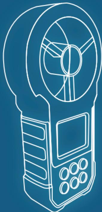
**Medidor digital de flujo y velocidad de aire (Anemómetro) / HER-440**
